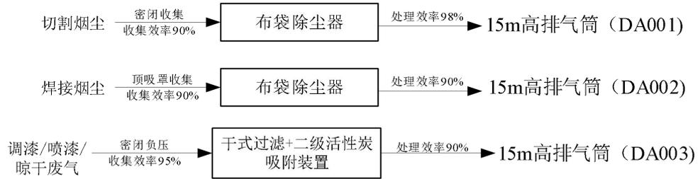
图 3.2-1 项目工艺废气治理及排放去向示意图
