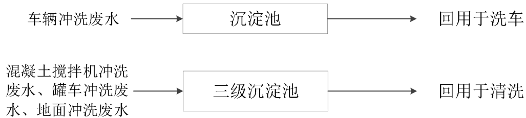
图 3.1-2 项目（一期工程）生产废水处理工艺流程图
