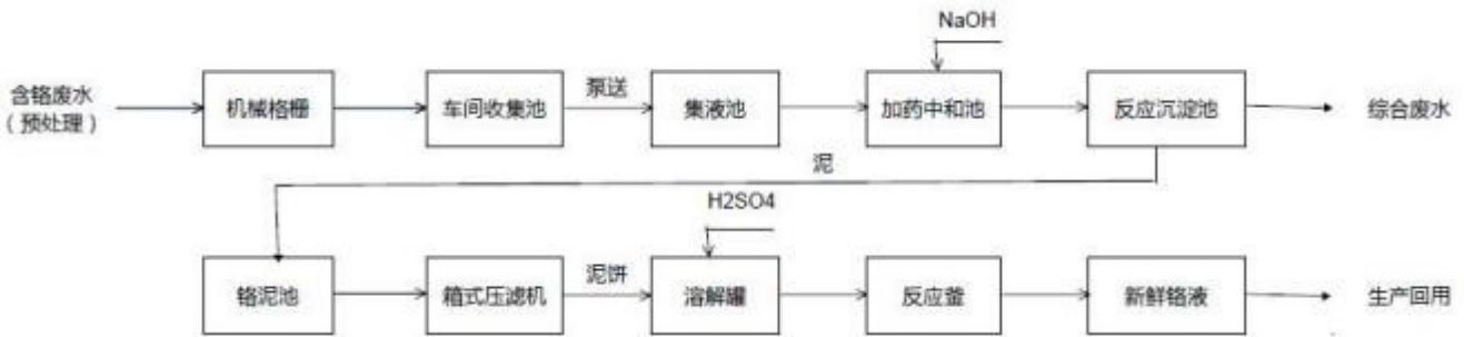
图2.6-2 含铬废水预处理工艺流程图
