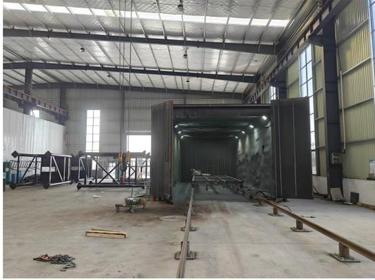
喷砂废气收集装置
