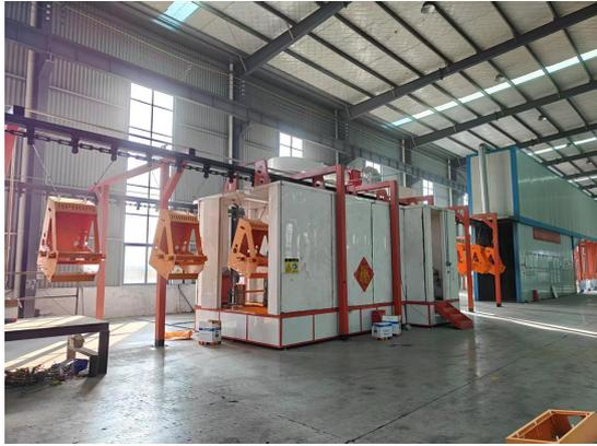
喷粉工序废气收集措施及除尘器
