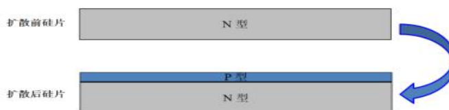
图 3.1-2 硼扩散原理示意图
